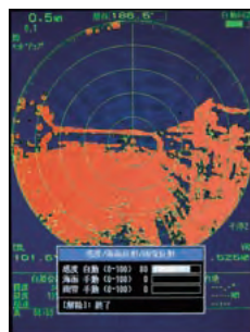
雨雪反射除去をOFF 陸上周辺が雨の反応に埋もれている。
