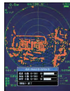
雨雪反射除去をON 雨に埋もれていたマリナーの形状がくっきりと浮き上がっている。
