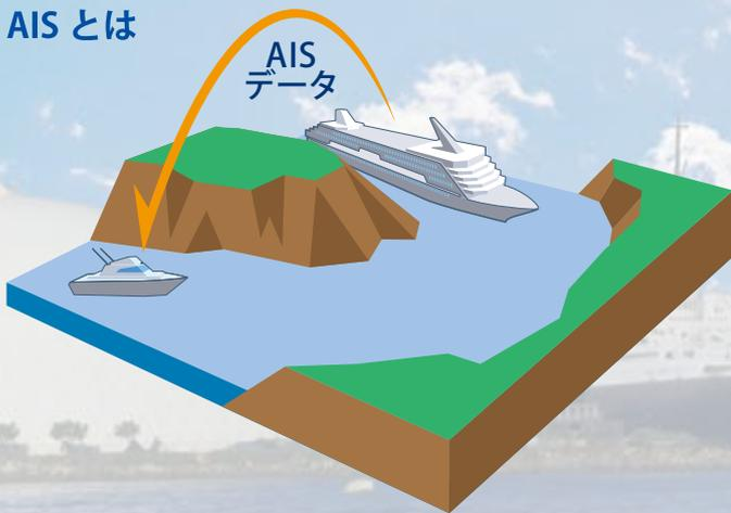
AIS(Automatic Identification System : 船舶自動識別装置)とは、船の位置や船速、進行方向等の情報を VHF 電波で受け取り、周辺の船舶の動静を把握するための装置です。濃霧や暗闇など、目視がきかない状況でも他船の動きを把握でき、安全な航海をサポートします。また、レーダーでは探知できない島影に隠れた船舶や、河口から出てくる船舶でも、AIS ならその存在を確認できるため、衝突防止の一助となります。
