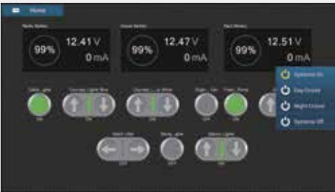
CZone控制&监控
