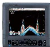
通过以太网接口，FCV-1150专业的渔探技术可以集成到NAVNET 3D系统中。只要在网线覆盖的范围内，这种先进的配置方式允许用户可以把FCV-1150安装在任何位置。在此种配置下，在FCV-1150和NAVNET 3D上都可以控制自动量程，自动增益，移位，放大控制。
