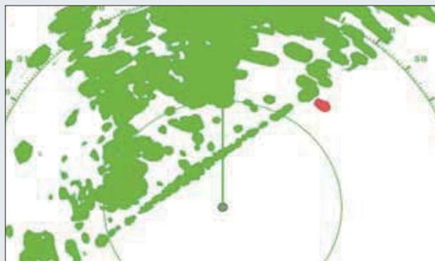
通过目标分析 (Target Analyzer™) 能够清楚地观察到移动目标向障碍物接近。
