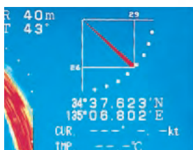
送受波器の角度が直感的に把握できる、 ティルトインジケータ
