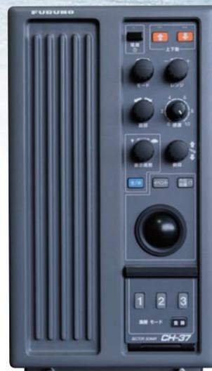
中層魚群はもちろん、底付魚群の探知能力にも抜群の威力を発揮するCH-37BBは、45度のセクタースキニング方式を採用したソナーであり、PPIソナーと比較して、旋回速度が約4倍もアップ(300mレンジ時)しています。さらに、水平モードや垂直断面モードとの併記で魚群状況を把握することで、魚群の中心や密集・分布状況が素早く読み取れます。また、海底形状を立体的に表示し、漁礁を始めとした海底の詳細状況を立体的に表示できる3Dモードで、底曳き漁などの漁場の把握に大きく貢献できます。周波数は、60, 113, 162 kHzを用意しており、リモートコントロールも標準で装備されています。また、表示部には幅広い視野角の19型縦型カラー液晶ディスプレイMU-190Vもオプションにてご用意しており、クオリティの高い映像表現をご提供します。(市販モニタの接続も可能)
