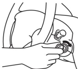
エンジンを始動するとETC車載器に電源が入り、自己診断が行われます。この間、左右のLEDが橙色点灯します。
