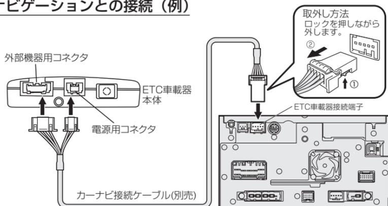
カーナビ接続ケーブルのコネクタをETC車載器本体に挿入する際は、最終位置(ETC車載器本体とカーナビ接続ケーブルのコネクタとのすきまがなくなる)まで、確実に挿入してください。最終位置まで挿入すると「カチッ」という音がし、完全にロックします。
