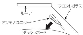
4. アンテナユニットのケーブルをケーブルクランプで留めながら配線します。
