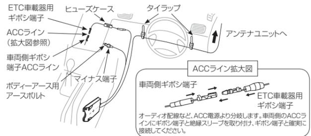
2. 電源ケーブルのコネクタをETC車載器本体の電源用コネクタに挿入します。
