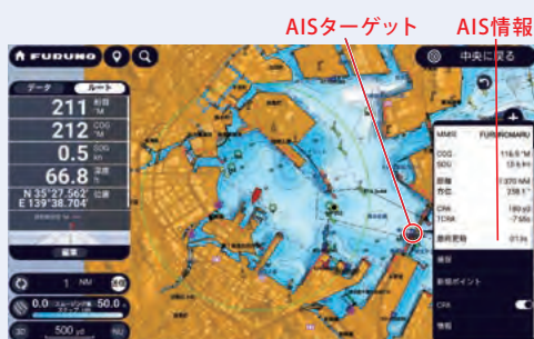
AISターゲットをタップするとターゲット船の情報を表示
