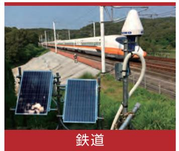
自然斜面、切土・盛土の変位監視、埋め立て時の沈下量管理、近接工事による影響を監視
