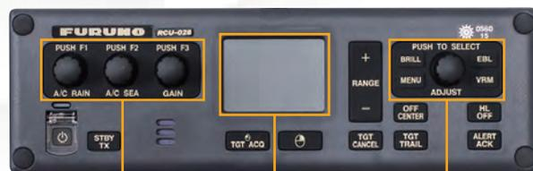
感度/海面反射除去/雨雪反射除去調整つまみ    カーソル移動用タッチパッド    航法ツールメニュー項目の操作
