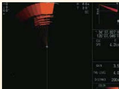
全周A型扫描模式可以单色显示最新探测到的回波。更强的色彩，表明更强的回波。回波强度可清晰显示并且更易了解该回波的特性。
