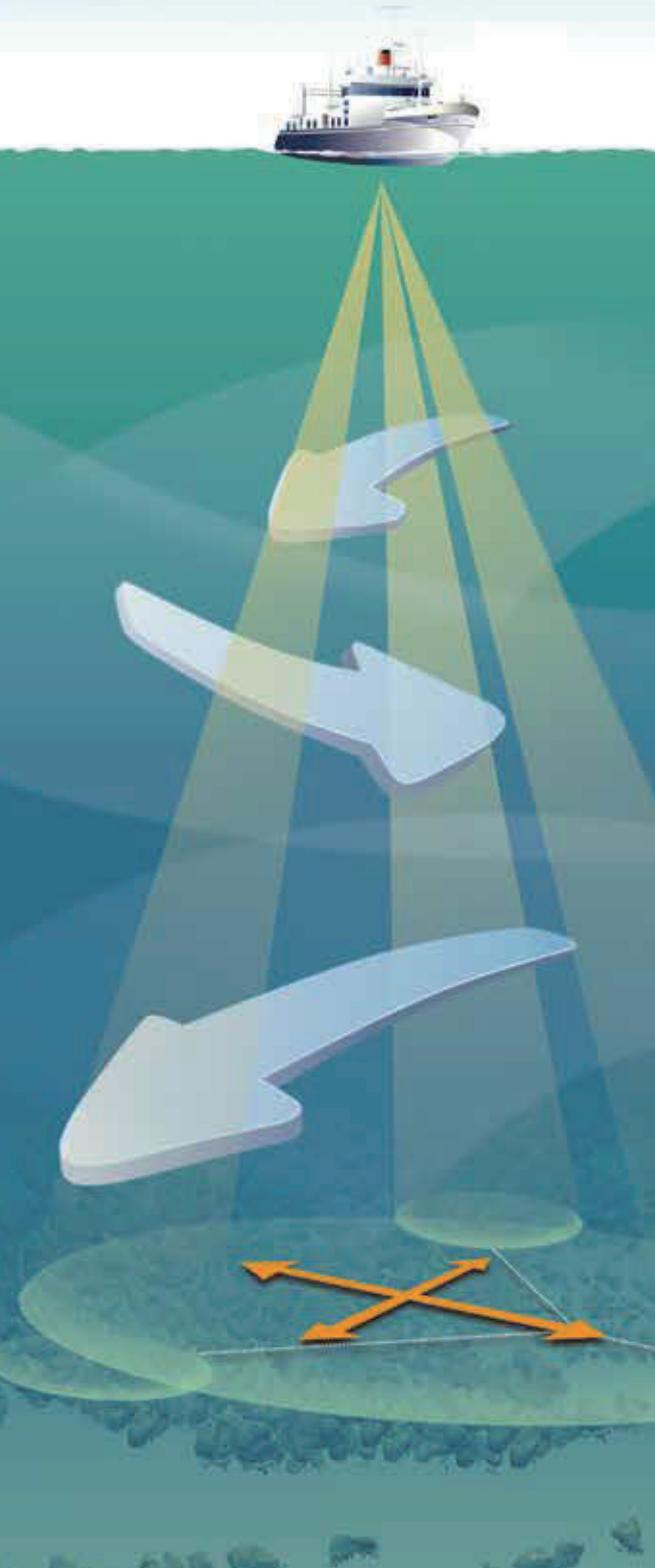
FURUNO CI-88是一款多普勒声纳潮流计，专为各种类型的渔船和水文测量船设计。高清晰 10.4 英寸彩色液晶显示屏以三个深度层级同时显示潮流速度和方向与船只速度和漂移。这种水流信息可用于预测渔网形状，并计划何时撒网。
