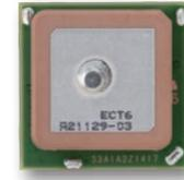
GH-85/GH-33はアンテナを含む受信機能をすべて詰め込んだ小型、高感度のGPS受信モジュールです。ハンドヘルドアプリケーションに適しております。
