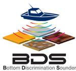
水深5～100 mの間の海底質を、岩・小石・砂・泥の4種類の底質タイプに分類し、魚探画面上に海底の状態をわかりやすく表示します。底質の種類やその変化、魚のサイズ、水深などを知ることにより、狙った魚の生息域に応じたベストポイントの選定に役立ちます。
