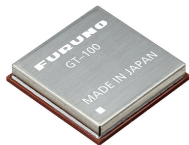
全世界のGNSSに対応し、L1/L5帯の2周波受信をサポートする新世代の時刻同期用GNSS受信モジュール「GT-100」
