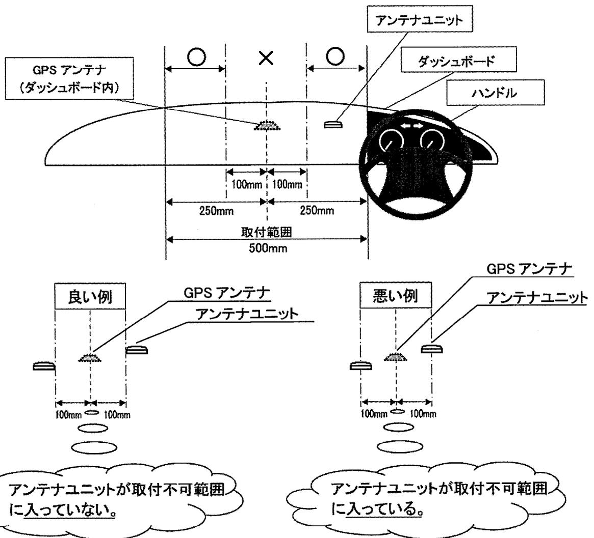
注1) GPS アンテナは通常、ダッシュボード内中央(モニター上など)に取付けられています。(GPS アンテナの取付位置は、車両メーカーやカーディーラー店に確認してください。)
